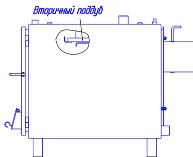
Рисунок 1.2 Система дожига отводимых газов
