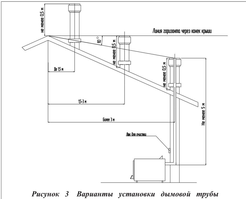
Рисунок 3 Варианты установки дымовой трубы
